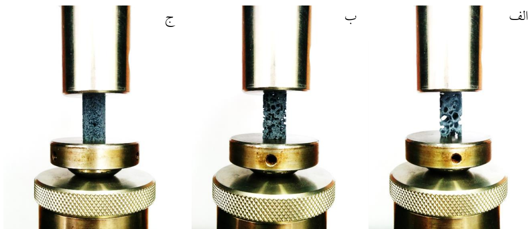
شکل ۱- نمونه‌های ماکرومتخلخل سرامیکی در اندازه حفره‌های مختلف و نحوه قرارگیری طی آزمون استحکام فشاری بر طبق استاندارد ASTM E9: الف) RPC80_A، ب) RPC80_B و ج) RPC80_C
