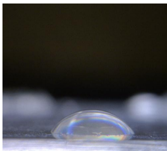
شکل ۶- زاویه تماس قطره آب روی لایه نازک فلورید منیزیم لایه‌نشانی شده به روش سل-ژل
