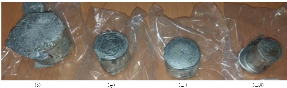
شکل ۳- نمونه مذاب کوئنچ شده پس از: الف) ۲۰، ب) ۱۵، ج) ۱۰ و د) ۵ ثانیه هم‌خوردن از دمای ۶۴۰ درجه سانتی‌گراد
