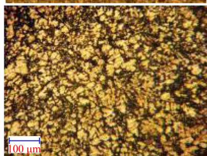
شکل ۶- تصاویر ریزساختار نمونه‌های ریخته‌گری با افزودن براده به سطح مذاب و کف بوته در دماهای مختلف (رنگی در نسخه الکترونیکی)
