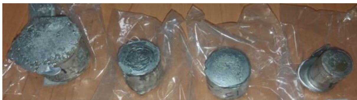
شکل ۳- نمونه مذاب کوئنچ شده پس از: الف) ۲۰، ب) ۱۵، ج) ۱۰ و د) ۵ ثانیه هم‌خوردن از دمای ۶۴۰ درجه سانتی‌گراد
