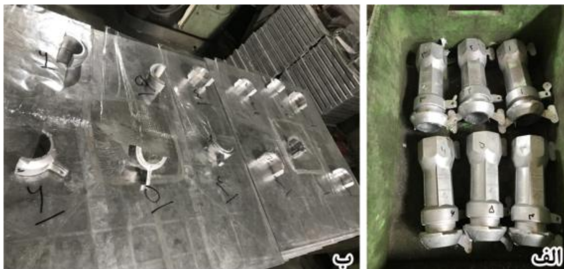
شکل ۲- الف) قطعات ریخته‌گری تحت فشار شده پس از عملیات افزودن براده و ب) مقطع برش خورده از قطعات دایکاست به منظور بررسی‌های ریزساختاری
