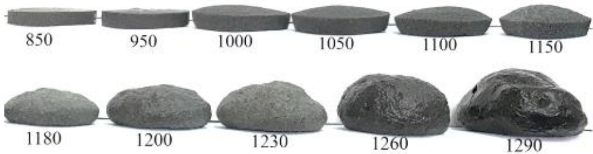
شکل ۹- تصویر ظاهری نمونه SG50-5SiC تفجوشی شده در دماهای مختلف
