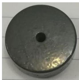
شکل ۳- قطعه منیزیم گرد بعد از پوشش دولایه PEO/Polyurethane
