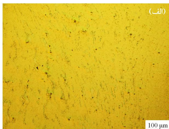
شکل ۶- الف) ریزساختار منطقه ترمومکانیکال نمونه جوشکاری شده در سرعت چرخشی ۱۰۰۰ دور بر دقیقه، ب) تصویر در بزرگ‌نمایی بالا که نشان‌دهنده انحلال کامل رسوبات \gamma ناپیوسته، خردایش مکانیکی و انحلال رسوبات \gamma یوتکتیک.
