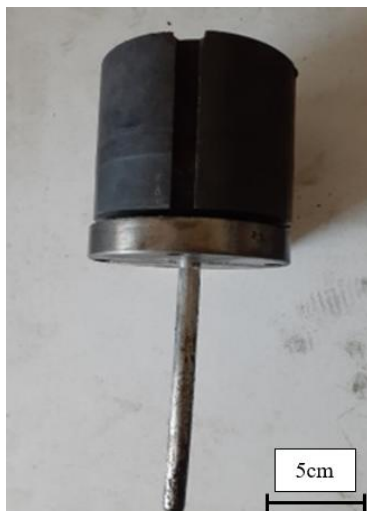
شکل ۳- قالب اکستروژن پس از انجام عملیات اکستروژن.
