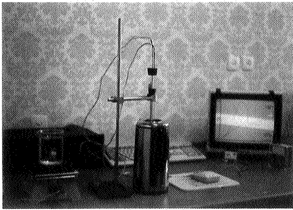
شکل ۴ - دستگاه اندازه‌گیر مقاومت الکتریکی برحسب دما
