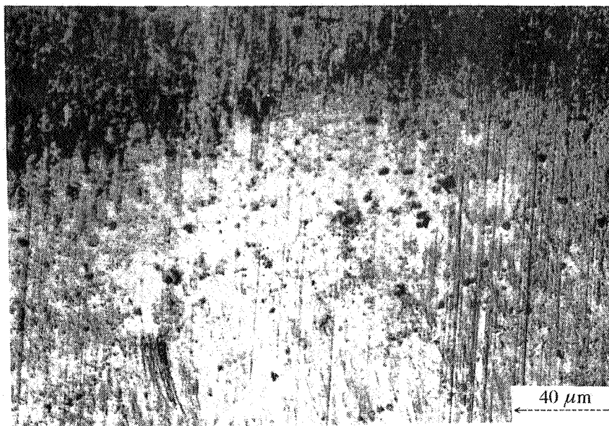
شکل ۱۰- میکروگراف نوری سطح سایش نمونه فولادی در تماس با پوشش Ti-Ni-P
