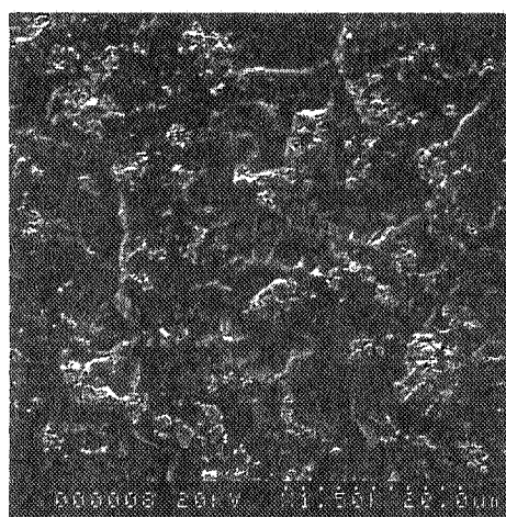
شکل ۸ - جوش اصطکاکی WC-6 wt.%Co / Ti6Al4V
