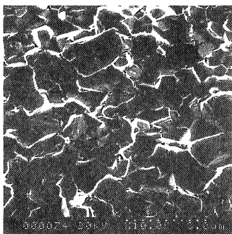
شکل ۸ - جوش اصطکاکی WC-6 wt.%Co / Ti6Al4V
