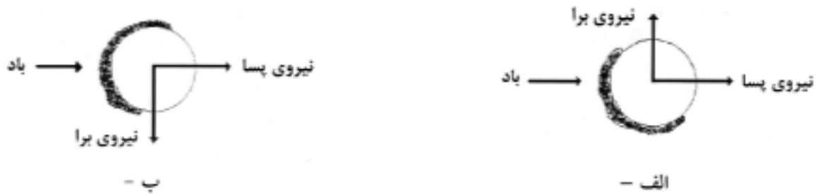
شکل ۱- نیروهای برا و پسا بر روی هادی با پوشش یخ
