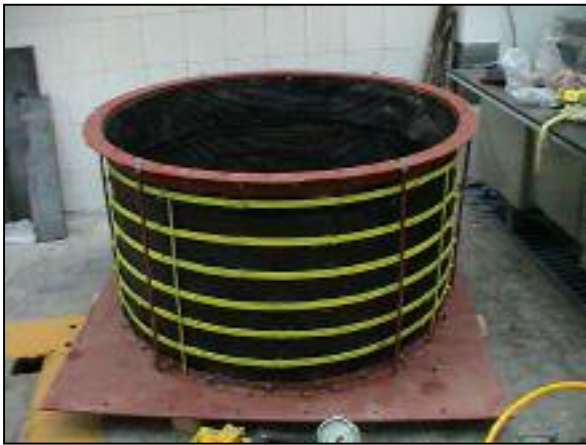
شکل ۱۰- نمایی از ظرف مدل خاک ساخته شده
