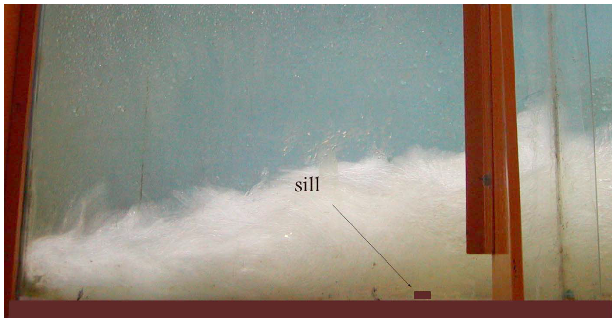
شکل ۱۳- چگونگی تشکیل جریان در حالت یک دیواره s_1 = 5 \text{ mm} ( Q = 31/71 \text{ L/sec} )
