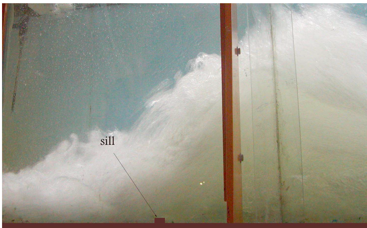
شکل ۱۴- چگونگی تشکیل جریان در حالت یک دیواره s_1 = 20 \text{ mm} ( Q = 61/83 \text{ L/sec} )
