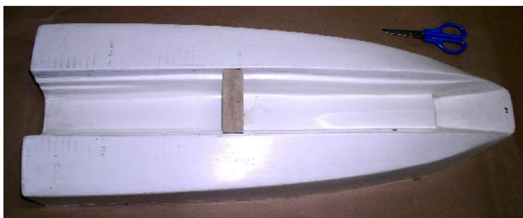
شکل ۷- مدل هیسوکت با آرایش تک هیدروفویلی
