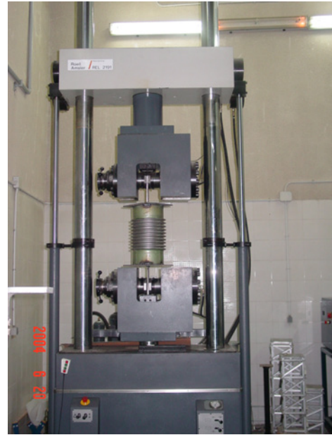
شکل ۴- آرایش آزمایش و دستگاه هیدرولیکی کشش و فشار دینامیکی
