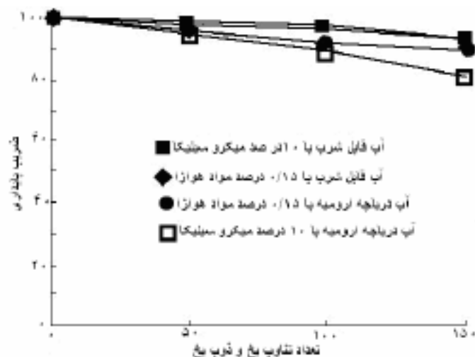
شکل ۱۴- مقایسه رفتار مخلوطهای مختلف در مقابل یخ و ذوب یخ در آبهای معمولی و دریاچه ارومیه
