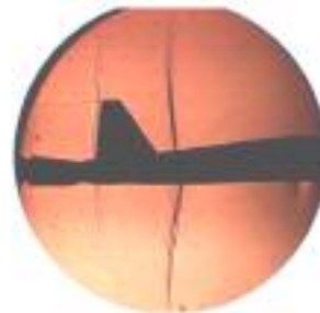
شکل ۳-ه) موج ناپایا در انتهای مدل با دم عمودی دوتایی در زمان راه اندازی تونل، \alpha=0
