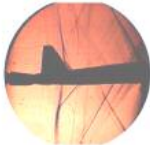
شکل ۳-و) موج ناپایا در انتهای مدل با دم عمودی دوتایی بعد از گذشت زمان
