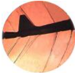
شکل ۳-د) موج ناپایا روی بخش انتهای مدل با یک دم عمودی، \alpha=6
