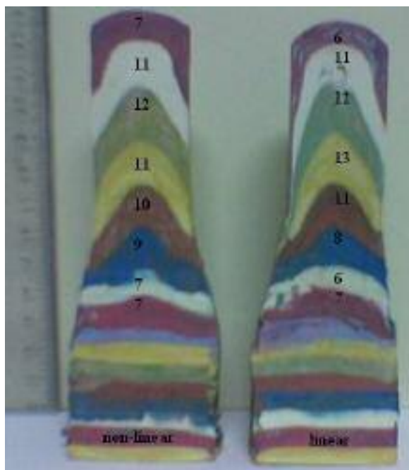
شکل ۲۰ - ضخامت لایه‌ها بر روی محور اکستروژن
