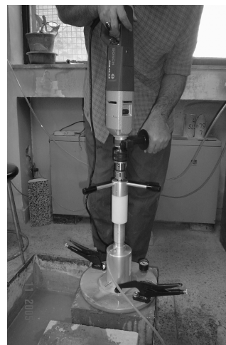
شکل ۴- مغزه گیری از نمونه
