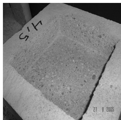
شکل ۳- نمونه آزمایش کشش مستقیم
