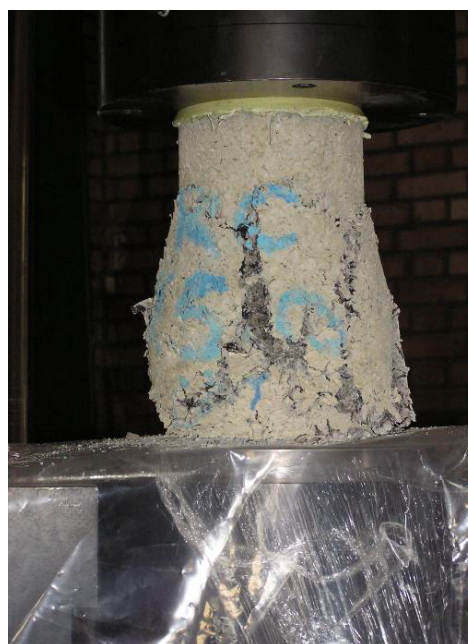
شکل ۴- تغییر شکل عرضی قابل توجه در نمونه‌های بتن لاستیکی
