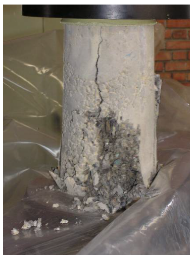
شکل ۱- وضعیت شکست در بتن معمولی
