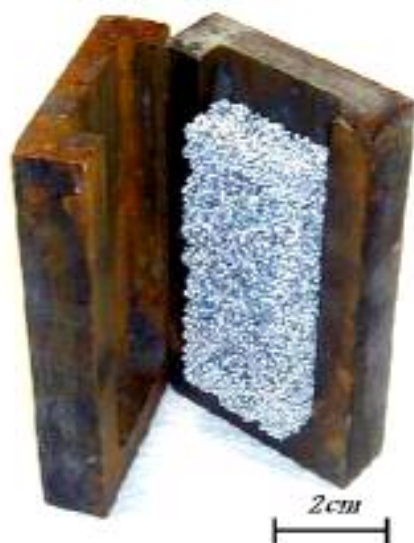
شکل ۱۱- نمایی از قالب فلزی و نحوه قرارگیری مدل فومی آغشته در داخل قالب.
