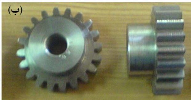
شکل ۱- قطعات چرخ‌دنده مورد آزمایش؛ (الف) نقشه مکانیکی (ب) قطعات واقعی.
