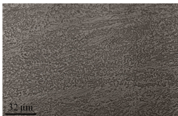
شکل (۴-ج) - ریز ساختار نهایی نمونه آزمایش شده در دمای ۸۵۰ درجه سانتیگراد و سرعت کرنش 5 \times 10^{-4} \text{ s}^{-1}
