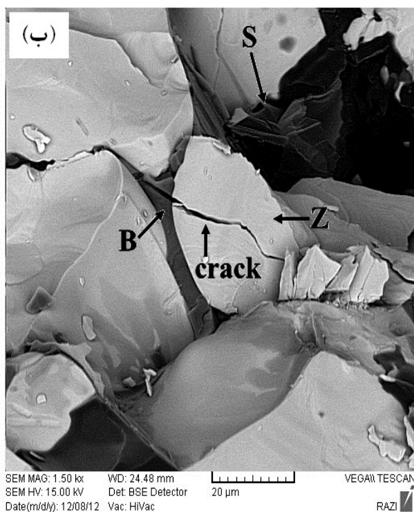
شکل ۹- تصویر سطح شکست نمونه ZSmBH تفجوشی شده در دمای: (الف) 2100^{\circ}\text{C} و (ب) 2150^{\circ}\text{C}
