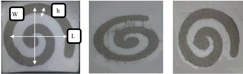
شکل ۱۳- پچ‌های ماریچ چاپ شده بر روی پارچه پلی استر در سه سایز مختلف نمونه ۱ نمونه ۲ نمونه ۳
