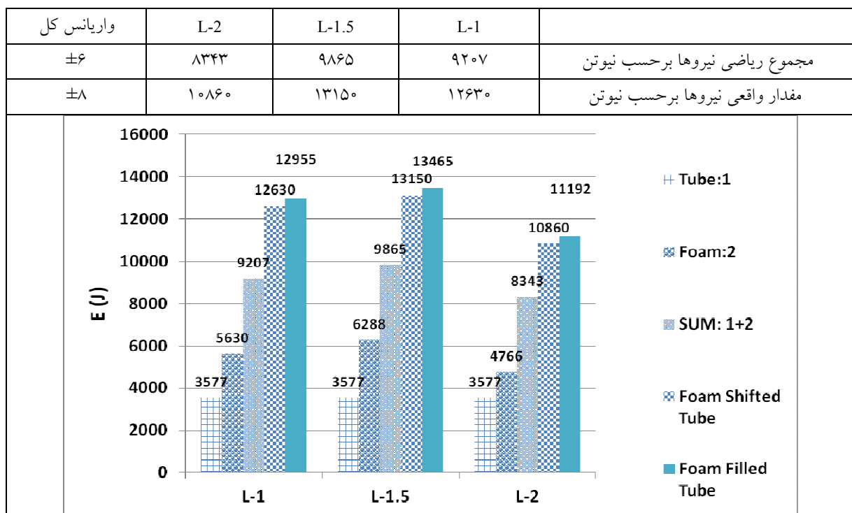
شکل ۱۴- مقایسه مقدار کمی جذب انرژی لوله‌های خالی برنجی، لوله‌های پر شده با فوم A356-10vol.%SiC در درصد‌های مختلف TiH 2 و استوانه فومی منفرد (بدون پوشش لوله برنجی).
