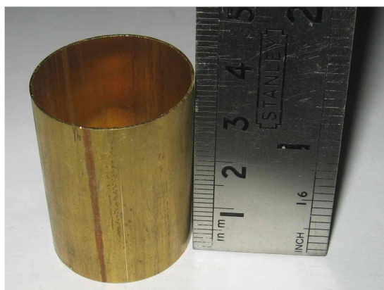
شکل ۵- لوله‌های برنجی استفاده شده با قطر ۲۷ میلی‌متر و ضخامت ۱ میلی‌متر و نسبت ارتفاع به قطر ۱/۵
