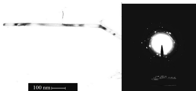
شکل ۱۰- تصویر TEM از ویسکر نمونه A 4 به همراه تحلیل SAED که در سمت راست ویسکر نشان داده شده است
