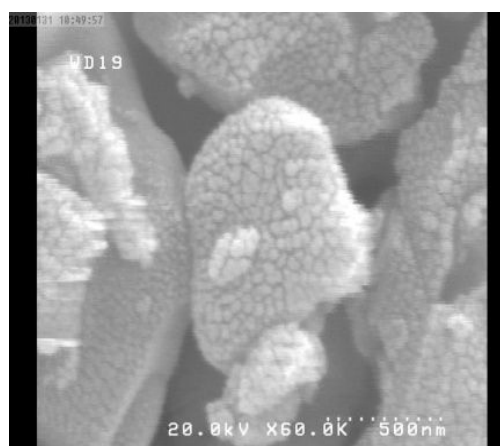
شکل ۳- تصویر میکروسکوپ الکترونی روبشی از شکل و اندازه ذرات سرامیک‌ها
