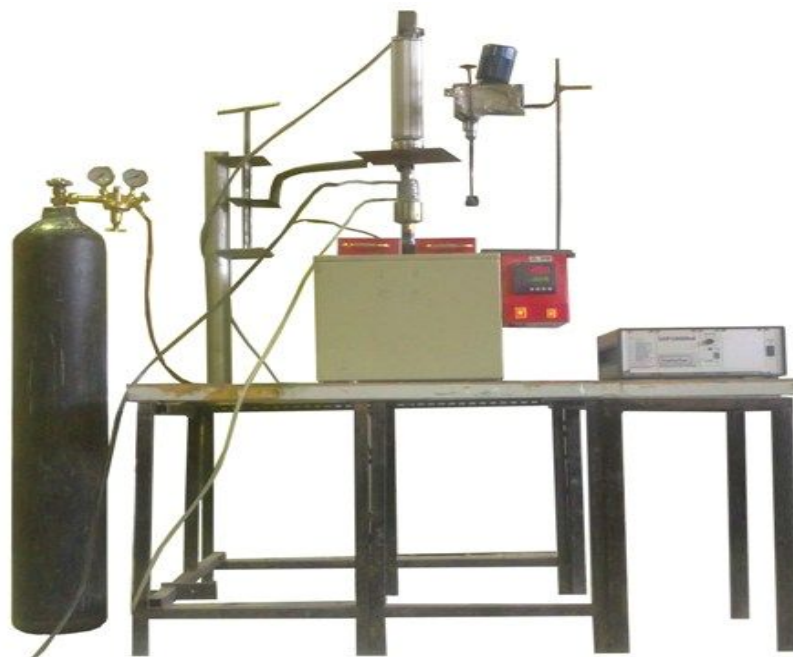
شکل ۴- تصویر سیستم مورد استفاده برای عملیات فراصوت روی مذاب
