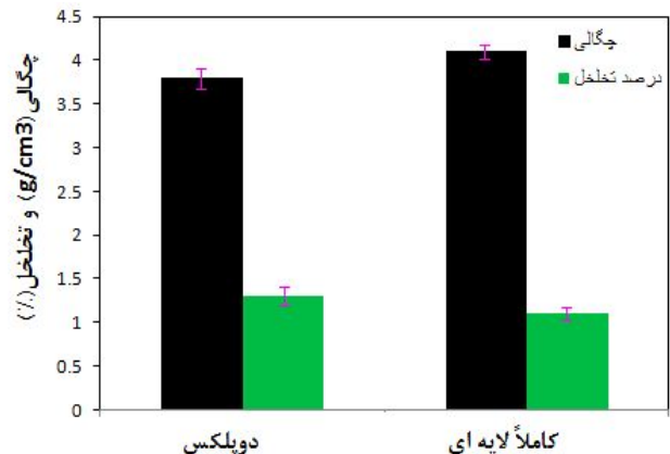
شکل ۸- مقایسه درصد تخلخل و چگالی نمونه‌های حجیم آلیاژ Ti_{47}Al_{48}Mn_5 با ساختارهای دوپلکس و کاملاً لایه‌ای
