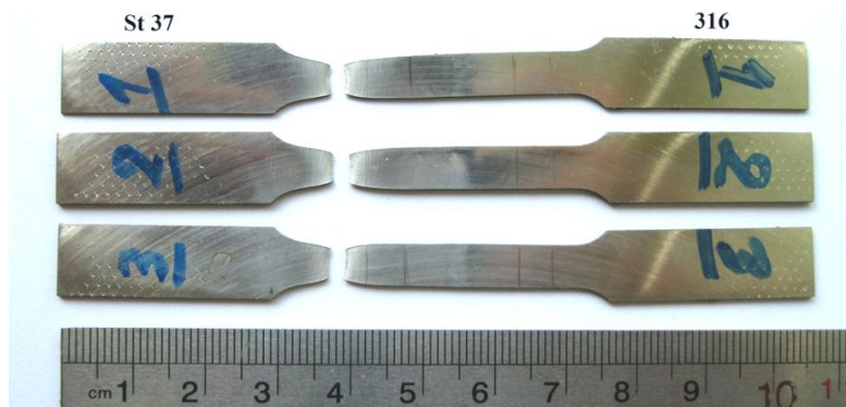
شکل ۱۱- نتایج آزمون کشش برای نمونه‌های جوش کاری شده
