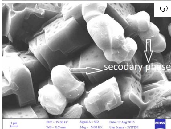
شکل ۴- تصاویر میکروسکوپی الکترونی روبشی از سطح مقطع شکسته شده شیشه و نمونه‌های کریستاله شده در دمای ۸۵۰ درجه سانتی‌گراد برای مدت ۸ ساعت: الف) \text{Cr}_{0.25} شیشه، ب) \text{Cr}_0 ، ج) \text{Cr}_{0.1} ، د) \text{Cr}_{0.25} ، ه) \text{Cr}_{0.4} و و) \text{Cr}_{0.5}
