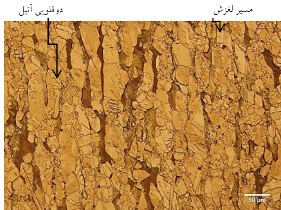
شکل ۲- ریزساختار نمونه پس از پاس اول
