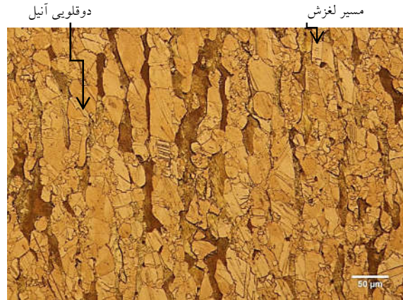
شکل ۲- ریزساختار نمونه پس از پاس اول
