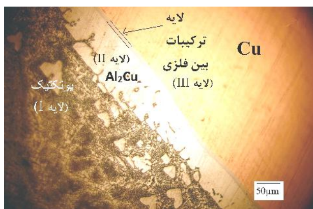
شکل ۳- لایه های I، II، و III در ریزساختار نمونه A750C300
