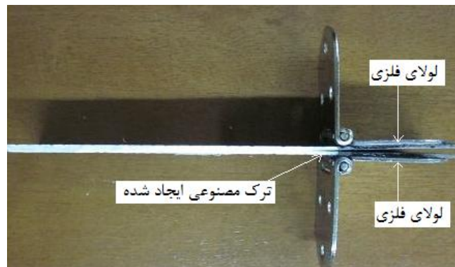
شکل ۲- نمایی از نمونه آماده شده برای آزمایش برش بین لایه‌ای نوع I
