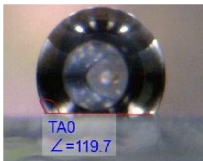
شکل ۱۰- زاویه تماس قطره آب روی شیشه لایه‌نشانی شده با پوشش فلورید منیزیم شش لایه و لایه نازک نانوکامپوزیتی MgF_2-2\%SiO_2 پس از اصلاح‌سازی
