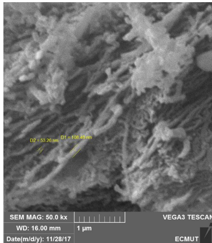
شکل ۵- تصویر میکروسکوپی الکترونی روبشی از کربن باقیمانده رزین فنولیک بعد از عملیات حرارتی
