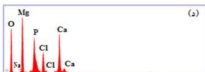
شکل ۴- تصاویر میکروسکوپ الکترونی روبشی مربوط به نمونه‌های: الف) AZ91 آندایز شده قبل از پوشش‌دهی و ج) با پوشش پلیمر پلی‌کاپرولاکتون-کیتوسان- یک درصد بغدادیت، آنالیز عنصری، ب) AZ91 آندایز شده قبل از پوشش‌دهی و د) با پوشش پلیمر پلی‌کاپرولاکتون-کیتوسان- یک درصد بغدادیت بعد از ۲۱ روز غوطه‌وری در محلول شبیه‌سازی شده بدن
