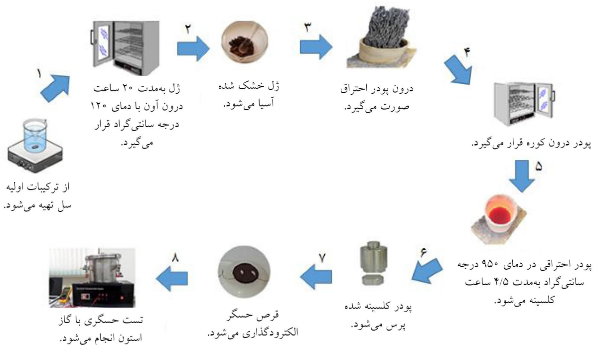
شکل ۱- روندنمای مراحل سنتز پودر و تهیه قرص فریت باریم- کلسیم
