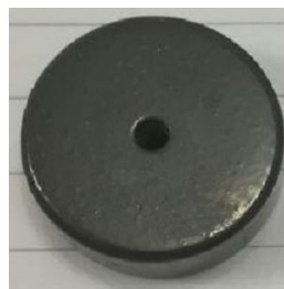
شکل ۱- قطعه منیزیم گرد بعد از پوشش دولایه PEO/FBE
