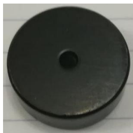
شکل ۲- قطعه منیزیم گرد بعد از پوشش دولایه PEO/Epoxy
