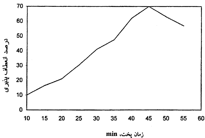
شکل ۵- تأثیر زمان پخت بر انعطاف پذیری در دمای پخت 230^{\circ}\text{C} درصد وزنی پایدارکننده ۰/۵، زیر لایه فسفات روی، زبری سطح سنباده ۱۱۰، دمای پخت 230^{\circ}\text{C} .
