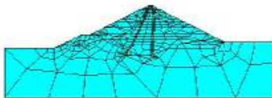
شکل ۷- مقطع میانی بالادست- پایین دست مدل اجزای محدود سد مارون با در نظر گرفتن ضخامت بستر سنگی برابر H
