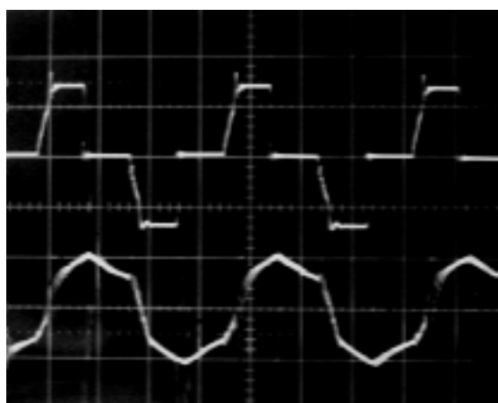
شکل ۱۴- ولتاژ و جریان اولیه ترانس (با ضریب وظیفه کم)
