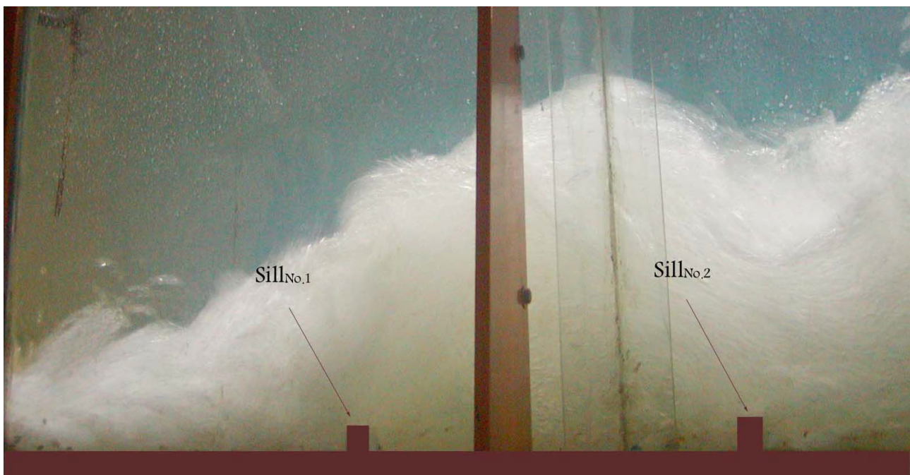
شکل ۲۵- چگونگی تشکیل جریان در حالت ترکیبی از دو دیواره s_2 = 30 \text{ mm} و s_1 = 20 \text{ mm} ( Q = 61/83 \text{ L/sec} )
