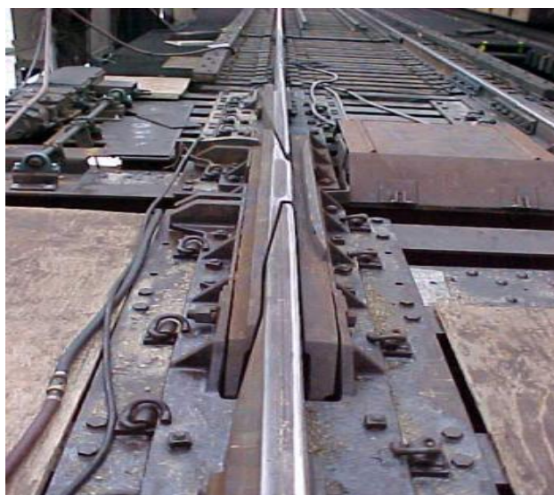
شکل ۲ - جوش درز ریل [۱۱، ۹]
